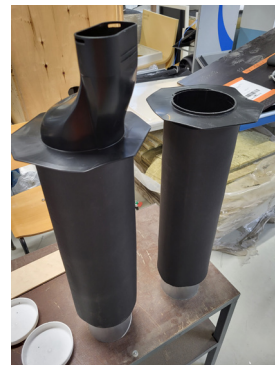
Kuva 2. IO-lisäpakettiin kuuluu kaksi eristettyä kanavaa ja lyhennetty adapteri asennettuna ulkoilmakanavaan. Ulkoilmakanavan tulppa on merkitty sinisellä ja jäteilmakanavan tulppa punaisella tarralla. Asenna IO-päätelaitteen mukana tuleva pitkä ulospuhallusadapteri jäteilmakanavaan.
